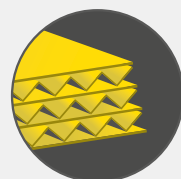
7 vrstvá vlnitá lepenka: nosnost cca 50 kg
