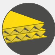
5 vrstvá vlnitá lepenka: nosnost cca 30 kg
