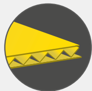
3 vrstvá vlnitá lepenka: nosnost cca 15 kg
